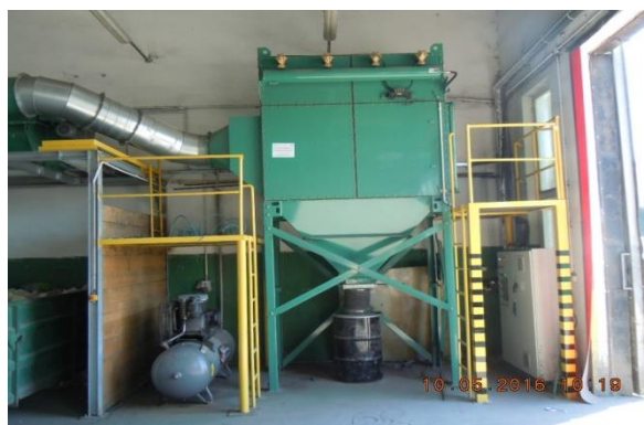
Rysunek 52 Sortownia odpadów komunalnych zmieszanych i selektywnie zebranych – separator powietrzny, Puszcza Miejska (foto. Puszcza Miejska, październik 2015r.)
