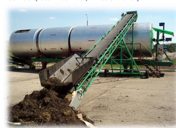
Rysunek 74 Komposter do przetwarzania odpadów zielonych, Machnacz (foto „Saniko” 2013r)- zlikwidowany w 2020r.
