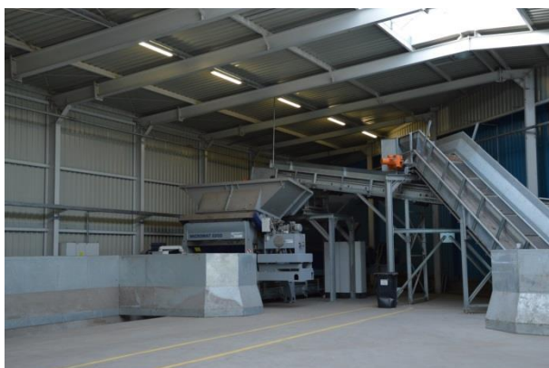
Rysunek 150 Instalacja produkcji paliwa alternatywnego – układ podawania i rozdrabniania, Inowrocław (fot: Inowrocław. Wrzesień 2015r)
