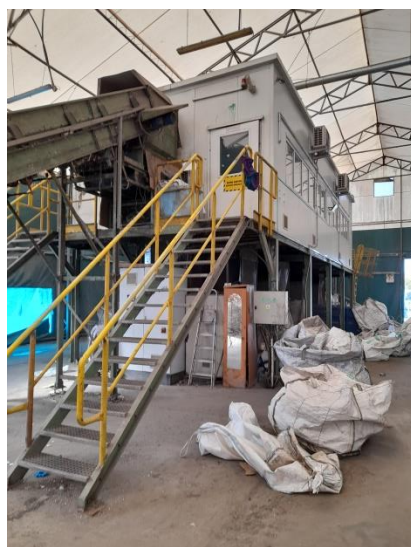
Rysunek 120 Sortownia odpadów zmieszanych i selektywnie zebranych- kabina sortownicza, Służewo (foto: Służewo, październik 2021r.)
