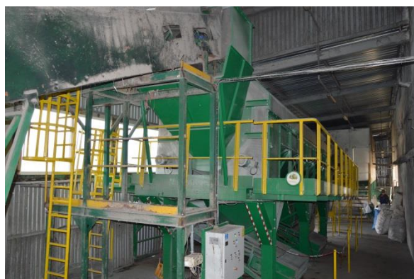
Rysunek 50 Sortownia odpadów komunalnych zmieszanych i selektywnie zebranych - sito bębnowe, Puszcza Miejska (foto. Puszcza Miejska, październik 2015r.)
