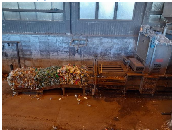
Rysunek 94 Sortownia odpadów komunalnych zmieszanych i selektywnie zebranych- prasa, Remondis Bydgoszcz (foto: październik 2021r.)
