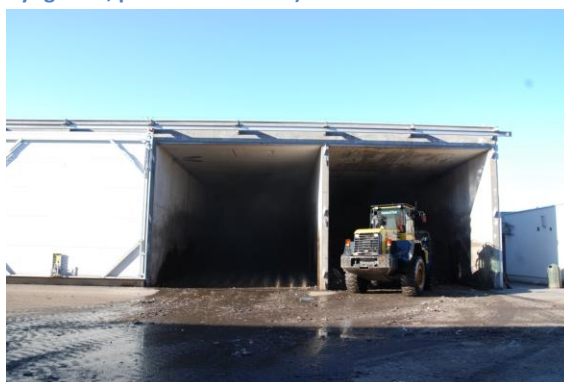
Rysunek 88 Instalacja stabilizacji frakcji biodegradowalnej wydzielonej ze zmieszanych odpadów komunalnych-napełnianie reaktorów, Remondis Bydgoszcz (sierpień 2013r)
