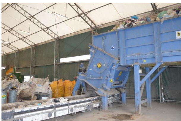
Rysunek 115 Sortownia odpadów zmieszanych i selektywnie zebranych- rozrywarka worków, Służewo (foto: Służewo, wrzesień 2015r)
