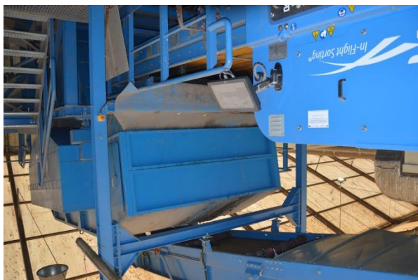
Rysunek 38 Sortownia odpadów (komunalnych zmieszanych i surowcowych)- separator optoelektryczny Osnowo (foto: Osnowo, październik 2021).
