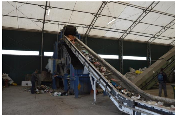
Rysunek 114 Sortownia odpadów zmieszanych i selektywnie zebranych- sito kaskadowe, Służewo (foto: Służewo, wrzesień 2015r)
