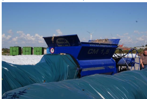
Rysunek 151 Tak było. Instalacja stabilizacji frakcji biodegradowalnej wydzielonej ze zmieszanych odpadów komunalnych- system rękawów foliowych, Inowrocław (sierpień 2013r) zlikwidowana
