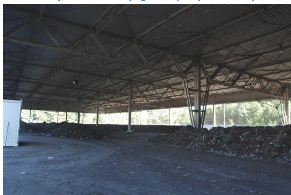
Rysunek 87 Instalacja stabilizacji frakcji biodegradowalnej wydzielonej ze zmieszanych odpadów komunalnych-bioreaktory, Remondis Bydgoszcz (sierpień 2013r)
