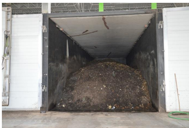
Rysunek 20 Instalacja do stabilizacji i kompostowania - w eksploatacji, Zakurzewo (foto: Zakurzewo, wrzesień 2015r).
