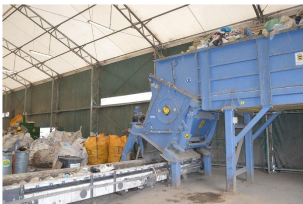
Rysunek 117 Sortownia odpadów zmieszanych i selektywnie zebranych- rozrywarka worków, Służewo (foto: Służewo, wrzesień 2015r)
