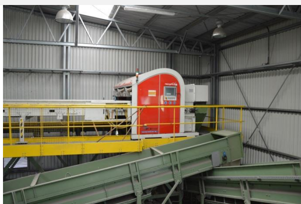
Rysunek 42 Separator optoelektroniczny w sortowni odpadów komunalnych, Nedźwiedź (foto: Nedźwiedź, wrzesień 2015r.)
