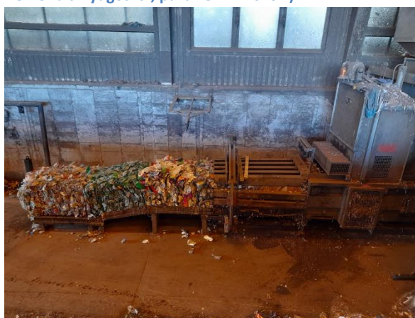
Rysunek 94 Sortownia odpadów komunalnych zmieszanych i selektywnie zebranych- prasa, Remondis Bydgoszcz (foto: październik 2021r.)
