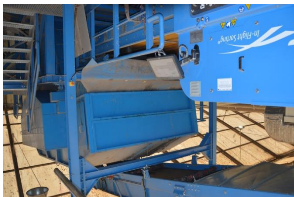
Rysunek 38 Sortownia odpadów (komunalnych zmieszanych i surowcowych)- separator optoelektroniczny Osnowo (foto: Osnowo, październik 2021).
