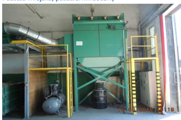
Rysunek 52 Sortownia odpadów komunalnych zmieszanych i selektywnie zebranych – separator powietrzny, Puszczka Miejska (foto. Puszczka Miejska, październik 2015r.)
