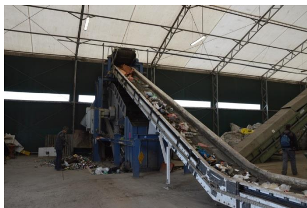
Rysunek 116 Sortownia odpadów zmieszanych i selektywnie zebranych- sito kaskadowe, Służewo (foto: Służewo, wrzesień 2015r)
