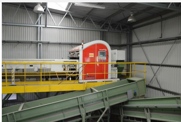
Rysunek 42 Separator optoelektroniczny w sortowni odpadów komunalnych, Niedźwiedź (foto: Niedźwiedź, wrzesień 2015r.)
