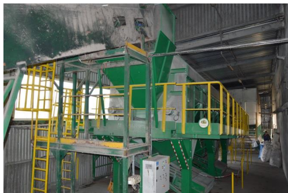
Rysunek 50 Sortownia odpadów komunalnych zmieszanych i selektywnie zebranych - sito bębnowe, Puszczka Miejska (foto. Puszczka Miejska, październik 2015r.)
