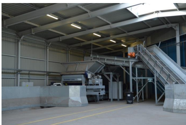
Rysunek 152 Instalacja produkcji paliwa alternatywnego – układ podawania i rozdrabniania, Inowrocław (fot: Inowrocław. Wrzesień 2015r)
