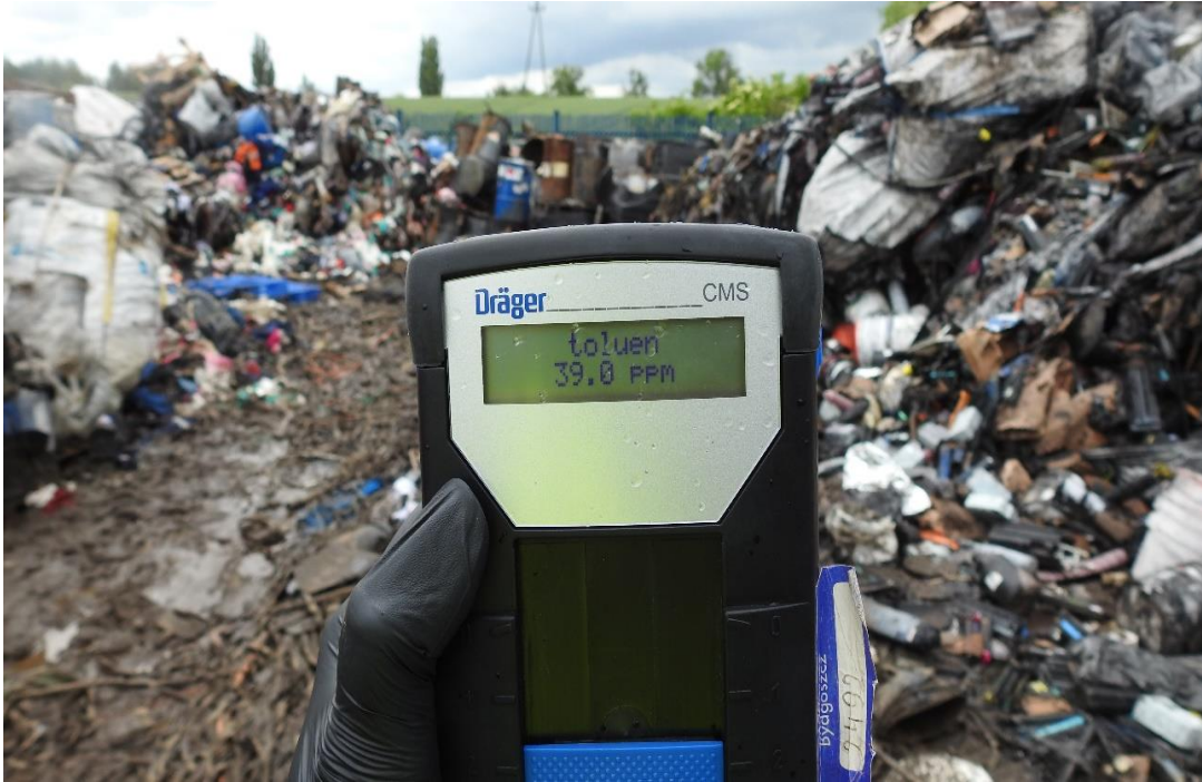
Zdjęcie nr 3. Pożar miejsca magazynowania odpadów w m. Ludzisko, gm. Inowrocław, powiat inowrocławski, w dniu 08.06.2020 r. Badanie obecności w powietrzu wybranych substancji z użyciem Detektora wielogazowego do wykrywania substancji chemicznych – System pomiarowy Dräger Chip Measurement System, zakupionego w ramach Projektu POLiŚ.
