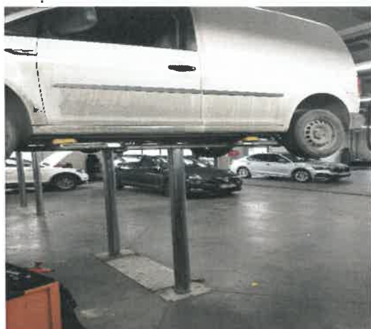
Stanowisko wyposażone w podnośnik przed oznaczeniem strefy niebezpiecznej.
