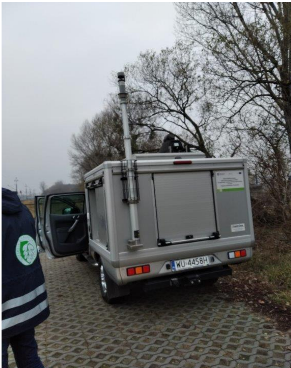
Zdjęcie nr 2. Mobilne laboratorium do pomiaru jakości powietrza.
